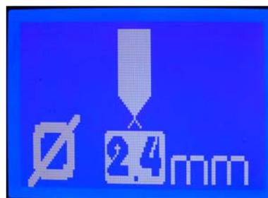
Il display mostra il diametro regolabile dell'elettrodo in AC
